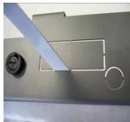
Den Ausschnitt für die Antenne brechen Sie mit einem kleinen Schraubendreher heraus.
