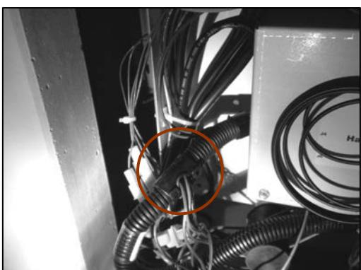
Aprire l'elemento di raccordo (uscita cavi) sul fascio di cavi e sfilare i due cavi del ventilatore tangenziale dal tubo passacavi. Richiudere l'elemento di raccordo (uscita cavi).
