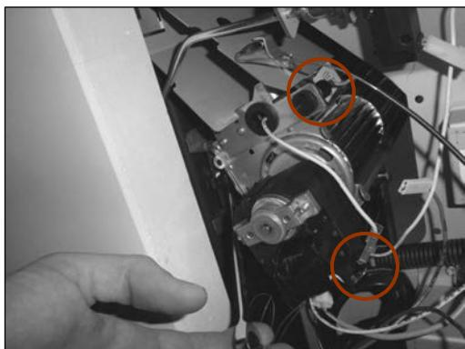
Befestigen Sie das Querstromgebläse mit den beiden mitgelieferten Unterlegscheiben und Sechskantmuttern.
