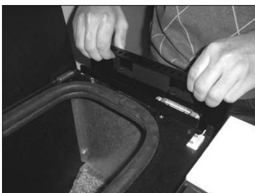
Sollevarre e rimuovere il rivestimento posteriore a destra, appoggiarlo quindi accanto alla stufa sopra una base morbida. Attenzione: il rivestimento laterale destro è collegato alla stufa tramite il cavo del pannello di controllo e un conduttore di terra.
