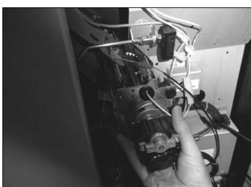
Dopo aver inserito il ventilatore tangenziale per circa la metà della sua lunghezza ruotarlo leggermente indietro (in senso antiorario) e spingerlo fino all'altezza dei perni filettati che sono predisposti per il fissaggio.
