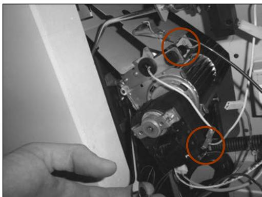
Fissare il ventilatore tangenziale con le due rosette e i due dadi esagonali forniti.
