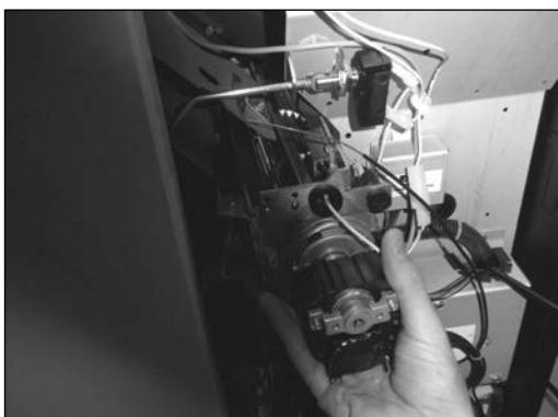
Drehen Sie das Querstromgebläse nach halber Strecke leicht gegen den Uhrzeigersinn zurück und schieben Sie es bis auf Höhe der Gewindestifte, die zur Befestigung vorgesehen sind, weiter.
