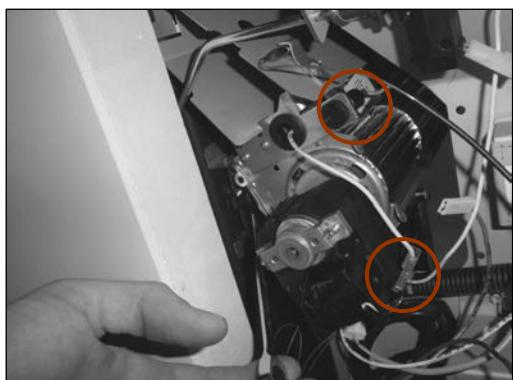
Fixez le ventilateur à l'aide des rondelles et des écrous fournis.
