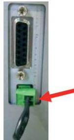
Entfernen Sie die Kabelbrücke an der sich am Ofen befindlichen Schnittstelle und klemmen Sie stattdessen das Kabel des Raumthermostates an.
