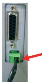
Rimuovere il ponticello sull'interfaccia che si trova sulla stufa e al posto di questo collegare il cavo del termostato.
