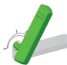
Drehen Sie den Steckschlüssel nach erfolgreicher Anheizphase schrittweise gegen den Uhrzeigersinn, um die Verbrennungsluft per Hand zu reduzieren und damit den Abbrand zu regeln.
