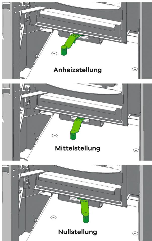
Die **Anheizstellung** darf ausschließlich zum Entzünden der Scheite beim Anheizen oder Nachlegen verwendet werden.
