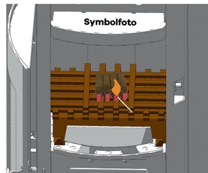
3. Allumez l'allume-feu (ou le papier non enduit) et refermez la porte du foyer. Un « allumage correct » permet d'éviter un développement de fumée excessif lors de la procédure.
