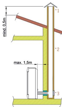
1) Paraviento, 2) chimenea, 3) apertura de inspección
