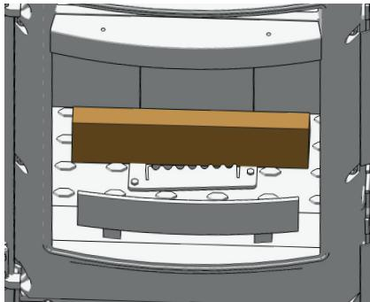
Avviare la stufa. Una volta completata l'accensione, la modalità **ACCENSIONE** passa a **CONTROLLO LEGNA**, quindi cambia in **FUNZIONAMENTO A LEGNA** dopo il corretto riconoscimento della legna.
