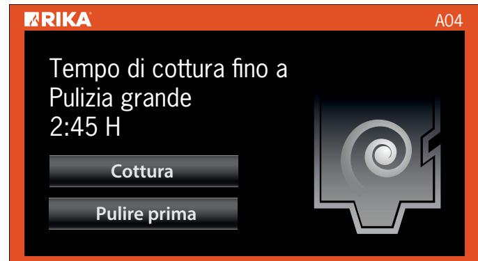
Selezionare COTTURA - BAKE se il tempo rimanente mostrato per la cottura è sufficiente.
