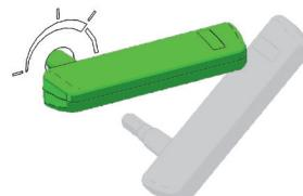
Ruotare la chiave a tubo in senso antiorario fino ad allinearla con il segno sul rivestimento laterale (circa 45°). La chiave si trova in posizione di accensione.
