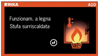
Durante il funzionamento con legna da ardere è stata rilevata una temperatura troppo elevata nella camera di combustione.
