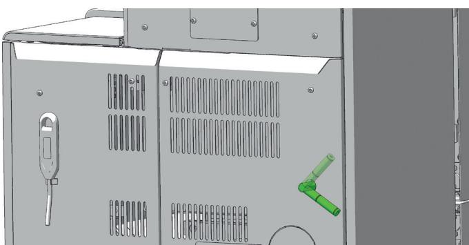
Dopo la cottura riportare la valvola di ventilazione nella posizione iniziale (in alto).
