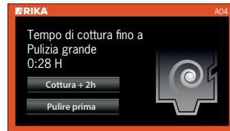
Ogni volta che si passa alla modalità forno, viene mostrato il tempo rimanente fino alla successiva pulizia automatica:
