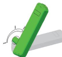
Ruotare progressivamente la chiave a tubo, dopo aver concluso correttamente la fase di accensione, in senso antiorario per ridurre il flusso d'aria manualmente e quindi impostare la combustione.
