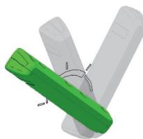
Per ricaricare con altra legna, è necessario riportare la chiave a tubo nuovamente in posizione di accensione. La regolazione del flusso dell'aria di combustione è descritta in precedenza.
