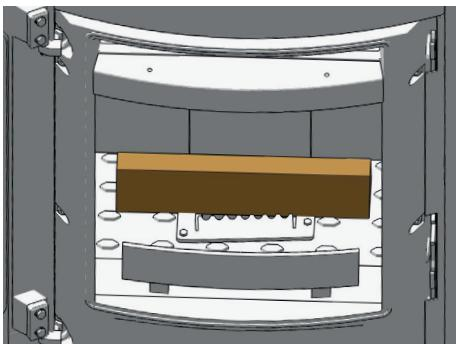
Iniciado del funcionamiento de la estufa. Tras un exitoso encendido, el estado de la estufa cambia de „Encendido“ a „comprobación de leña“, y tras la comprobación a „Funcionamiento en leña“.
