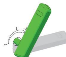
Después de un exitoso encendido, gire la llave en sentido contrario a las agujas del reloj paso a paso para reducir el aire de combustión manualmente, regulando así la combustión.
