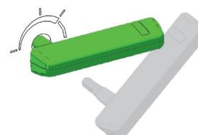
Tournez la clef dans le sens inverse des aiguilles d'une montre, jusqu'à ce qu'elle soit alignée avec la marque présente sur l'habillage latéral (env. 45°). Vous êtes maintenant en position de chauffe.
