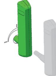
Tournez la clef dans le sens des aiguilles d'une montre jusqu'à la butée.
