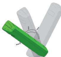
Lors de chaque rechargement en bois, la clef doit être remise à chaque fois en position de chauffe. La régulation de l'apport d'air de combustion s'obtient en reproduisant la manipulation décrite ci-dessus.
