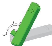
Après la réussite de la phase d'allumage, tournez la clef progressivement dans le sens inverse des aiguilles d'une montre, pour réduire manuellement l'apport d'air et réguler ainsi la combustion.
