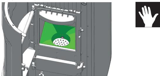
Effettuare la pulizia (con la spazzola) in modo delicato per evitare di danneggiare l'elemento di accensione. Aspirare il tubo del elemento di accensione.
